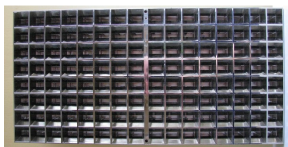
Рис. 4. Фотография антенного полотна и распределительной системы приёмной АР спутникового телевидения, выполненной по технологии гальванопластики
