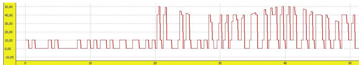
Рис. 3. Огибающая двух перекрывающихся друг друга сквиттеров со сдвигом по частоте
