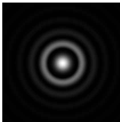
Рис. 1. Относительная интенсивность точечного объекта в дифракционном пятне (интенсивность колец увеличена)
