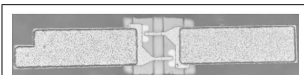
Рис. 4. Диодная сборка ДБШ
