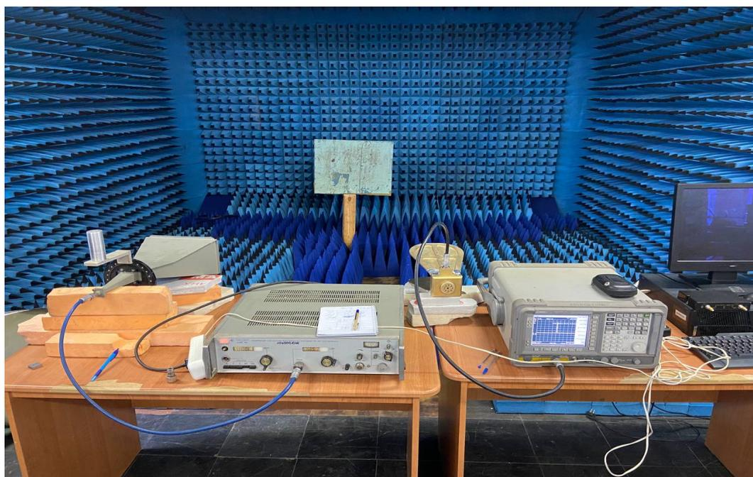
Рис. 4. Измерительная установка в безэховой комнате ВлГУ
