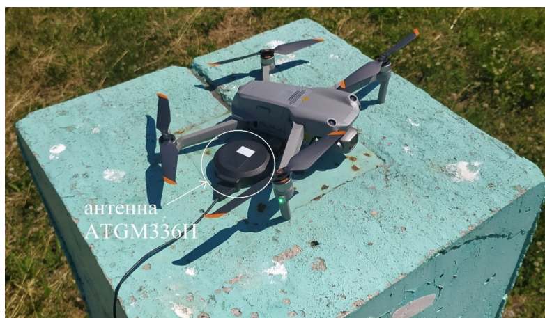
Рис. 1. Размещение БПЛА и ATGM336H в точке базиса
