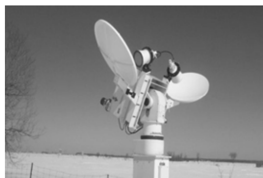
Рис. 4. Транспондер на полигоне в Оттаве для РСА «Radarsat-2»
