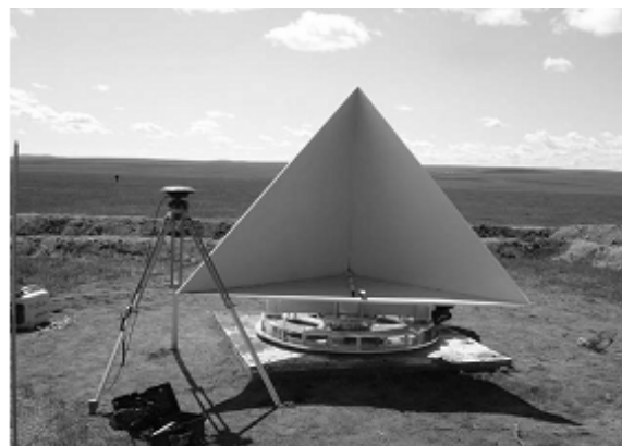
Рис. 2. Угловые отражатели для калибровки КОМPSAT-5
