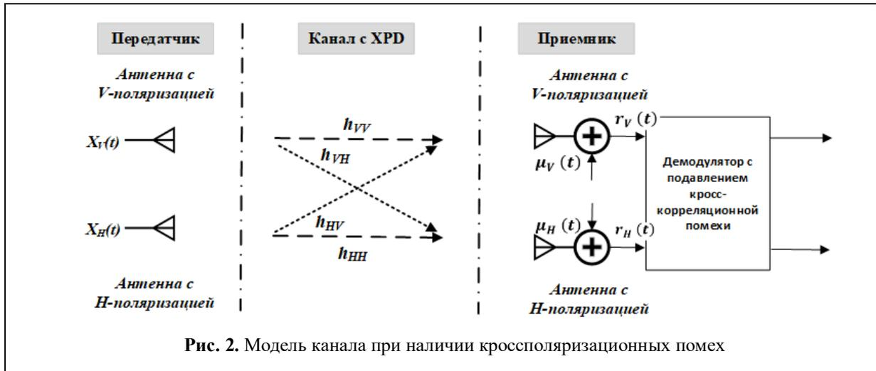
Рис. 2. Модель канала при наличии кроссполяризационных помех
