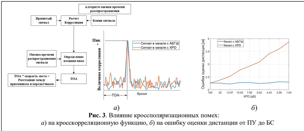
Рис. 3. Влияние кроссполяризационных помех: а) на кросскорреляционную функцию, б) на ошибку оценки дистанции от ПУ до БС
