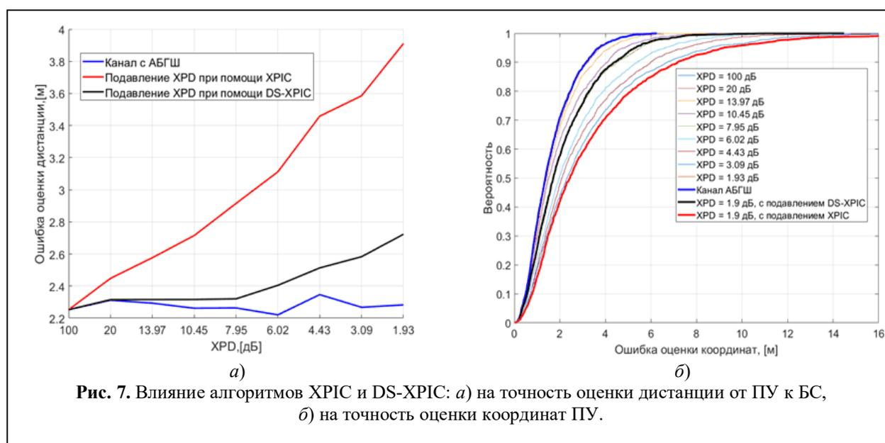
Рис. 7. Влияние алгоритмов XPC и DS-XPC: а) на точность оценки дистанции от ПУ к БС, б) на точность оценки координат ПУ.
