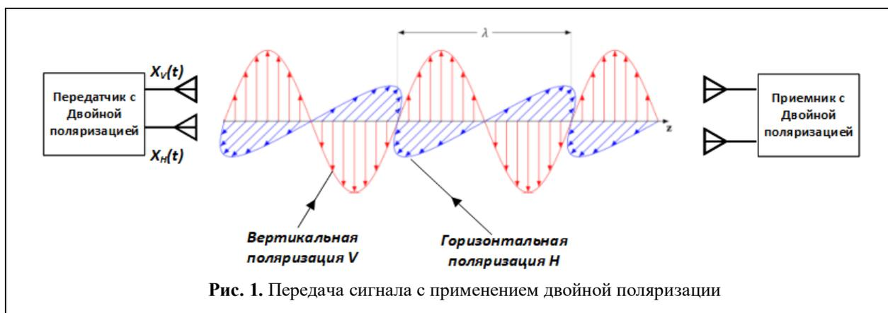
Рис. 1. Передача сигнала с применением двойной поляризации
