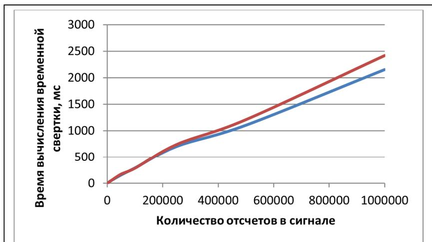
Рис. 16. Зависимость времени выполнения временной свертки сигнала для фильтров интерполяторов, собранных по схемам Крошье — Рабинера (синий) и Белланже (красный)
