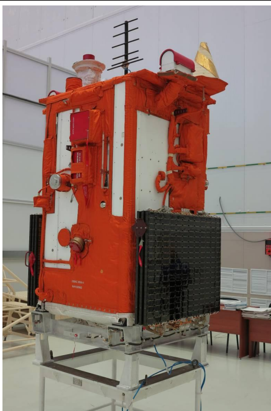
Рис. 1. Внешний вид КА «АИСТ-2Д» с антенной БиРЛК
