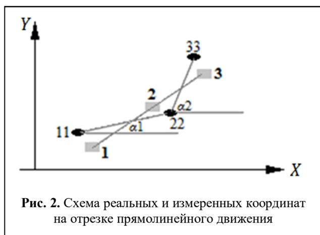
Рис. 2. Схема реальных и измеренных координат на отрезке прямолинейного движения
