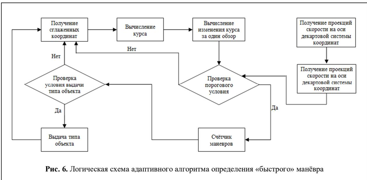
Рис. 6. Логическая схема адаптивного алгоритма определения «быстрого» манёвра
