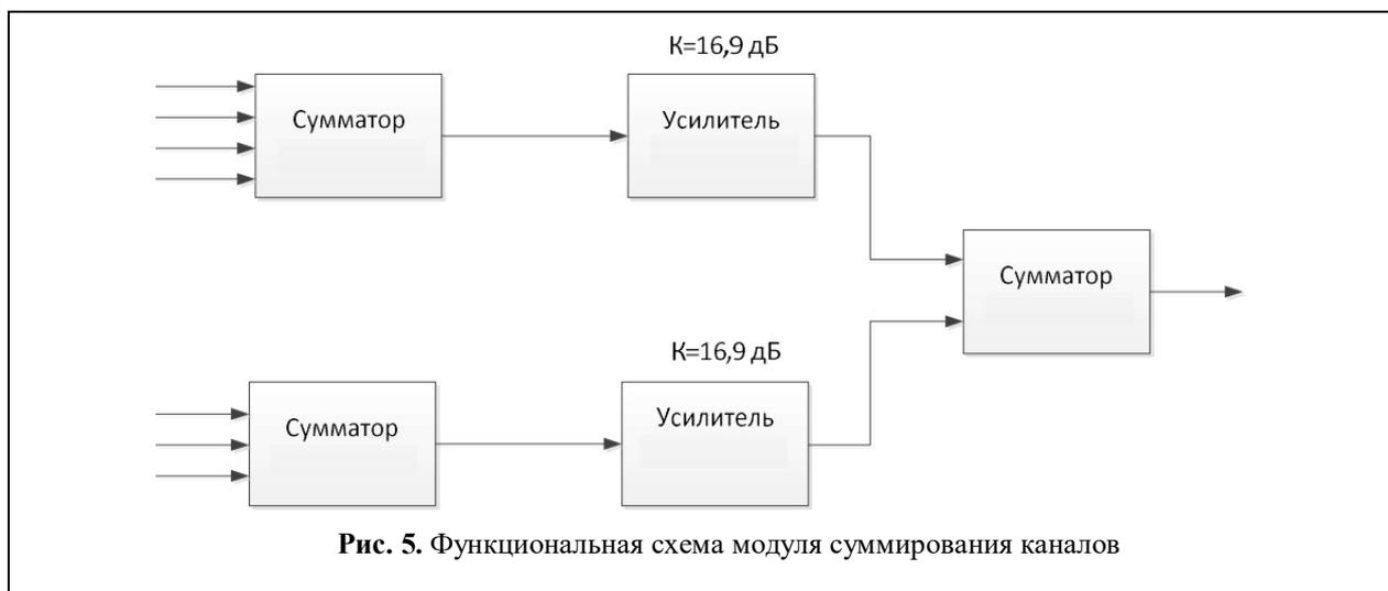
Рис. 5. Функциональная схема модуля суммирования каналов
