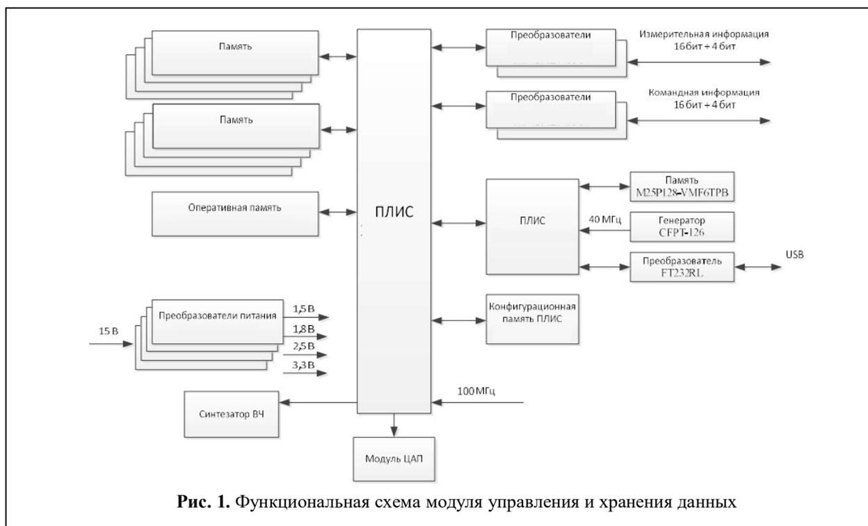
Рис. 1. Функциональная схема модуля управления и хранения данных
