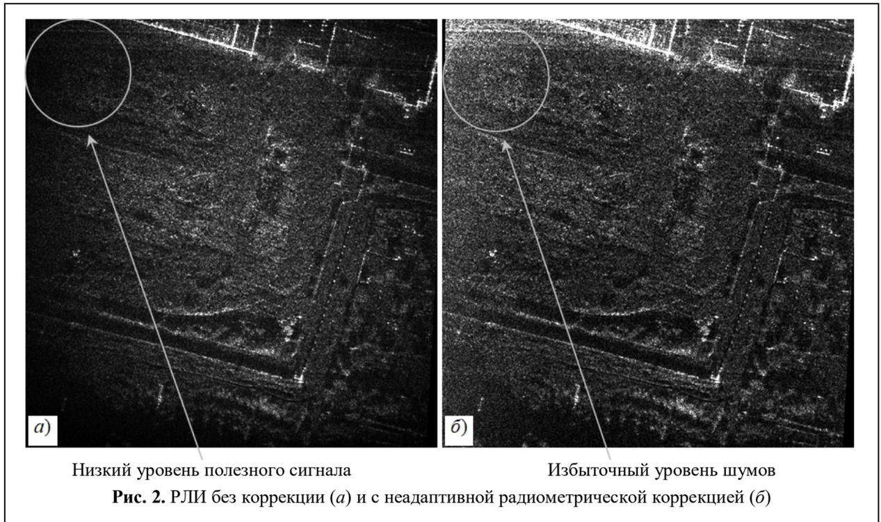
сформированные по записанной радиоголограмме без коррекции и с неадаптивной радиометрической коррекцией. На рисунке отмечена часть РЛИ, в которой из-за избыточного усиления по шумам образовалась засвеченная область в изображении.
