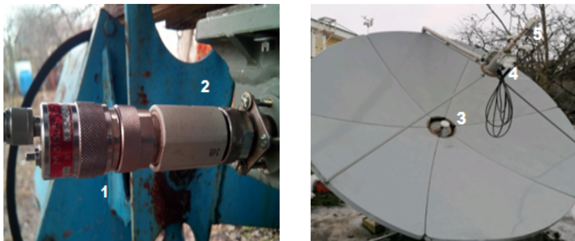
Рис. 2. Антенна трёхдиапазонной СВЧ радиометрической системы с внешним широкополосным источником шумового сигнала: 1 — генератор шума; 2 — аттенуатор; 3 — рупор источника шумового сигнала; 4 — облучатель трёхдиапазонной СВЧ радиометрической системы; 5 — трёхдиапазонный радиометр
