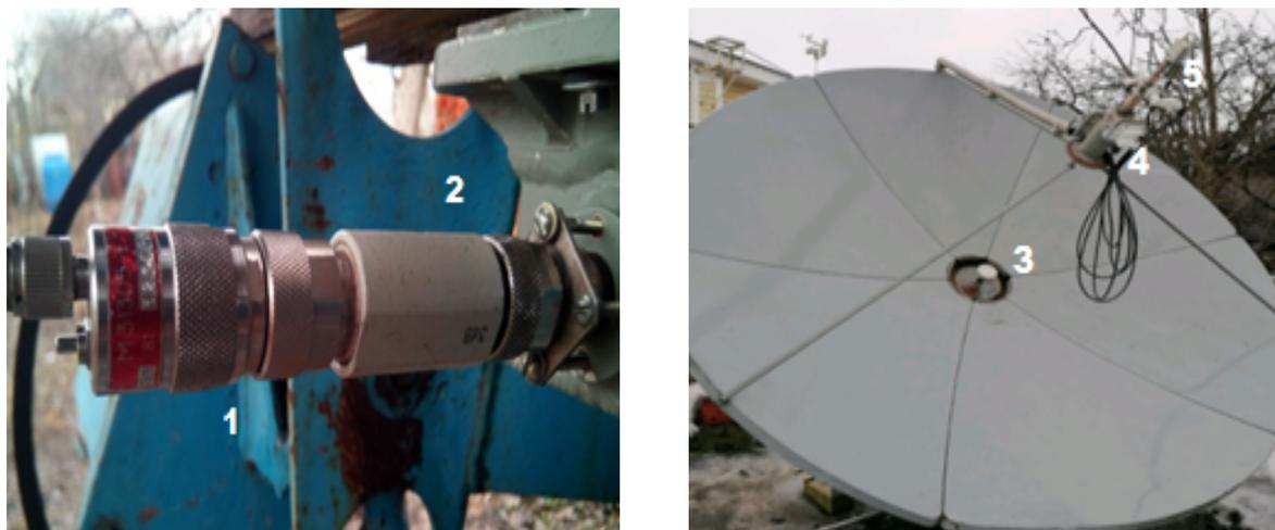
**Рис. 2.** Антенна трёхдиапазонной СВЧ радиометрической системы с внешним широкополосным источником шумового сигнала: 1 — генератор шума; 2 — аттенуатор; 3 — рупор источника шумового сигнала; 4 — облучатель трёхдиапазонной СВЧ радиометрической системы; 5 — трёхдиапазонный радиометр
