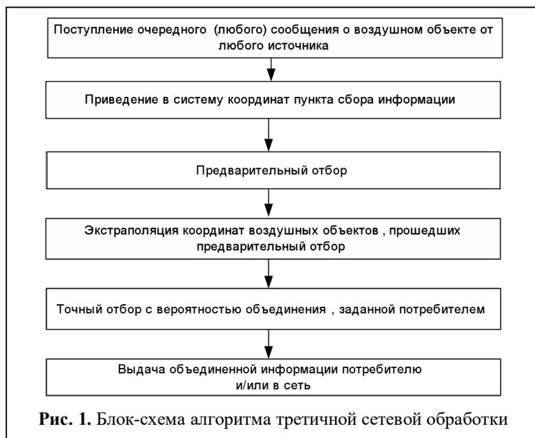
если использовать при объединении радиолокационной информации алгоритм сетевой обработки, предложенный в [16]. Особенность данного алгоритма заключается в объединении радиолокационной информации, поступающей в сетевую информационную систему, с информацией, находящейся в сети. При этом сама сеть своей структурой обеспечивает одноуровневую обработку и доставку информации потребителям с минимальной задержкой по времени.
