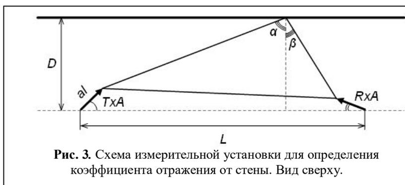
Рис. 3. Схема измерительной установки для определения коэффициента отражения от стены. Вид сверху.
