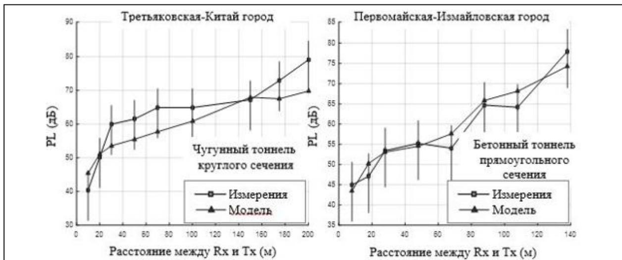
Рис. 5. Зависимости потерь мощности радиосигнала в зависимости от расстояния в прямых тоннелях
