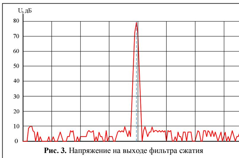
(НЧМ) импульс, отвечающий всем сформированным на тот момент требованиям, и прежде всего требованию величины боковых лепестков после сжатия не хуже  $-50$  дБ от максимального значения. За основу был взят модифицированный ЛЧМ импульс. Форма сигнала на выходе фильтра сжатия представлена на рис. 3 [15]. Достигнутый уровень боковых лепестков составил  $-71,7$  дБ, длительность на уровне  $-3$  дБ равна 1 мкс, коэффициент сжатия равен 60.
