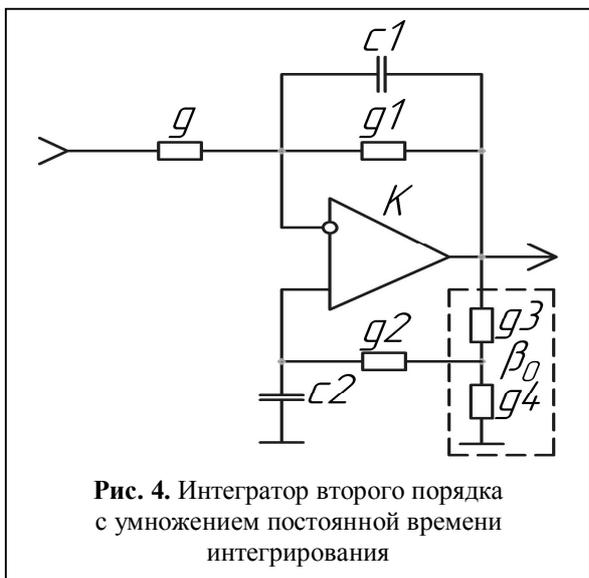
Рис. 4. Интегратор второго порядка с умножением постоянной времени интегрирования
