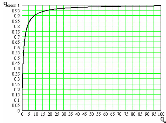
Рис. 1. Зависимость отношения сигнал-шум радиотеплолокационной системы от величины q_a при условии q_{пр} = 1
