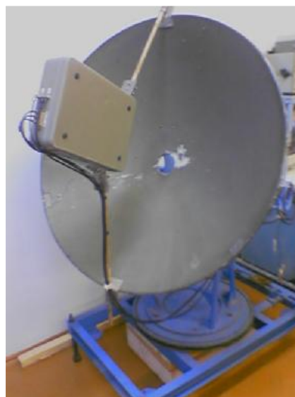
Рис. 1. - Антенное устройство радиотеплолокационной системы для лабораторных испытаний
