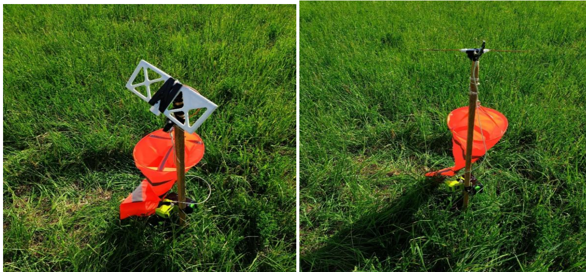
Рис. 21. – Антенные установки (антенна Моксона и диполь)
