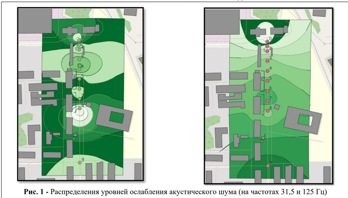
Рис. 1 - Распределения уровней ослабления акустического шума (на частотах 31,5 и 125 Гц)
