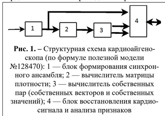
**Рис. 1.** — Структурная схема кардиоайгенокопа (по формуле полезной модели №128470): 1 — блок формирования синхронного ансамбля; 2 — вычислитель матрицы плотности; 3 — вычислитель собственных пар (собственных векторов и собственных значений); 4 — блок восстановления кардио-сигнала и анализа признаков
