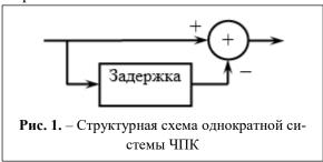
Отсчеты видеосигнала, огибающая которых изменяется в соответствии с частотой Допплера поступают на устройства ЧПК. На выходе устройства ЧПК формируется разность между текущим отсчетом и задержанным на один период. Если амплитуда отсчетов одинакова, то уровень сигнала на выходе устройства ЧПК будет равен нулю. Если амплитуда отсчетов сигнала изменяется в соответствии
