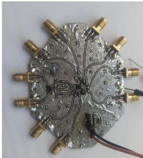
Рис. 6. – Печатная плата отладочного модуля ADCLK944 в собранном виде
