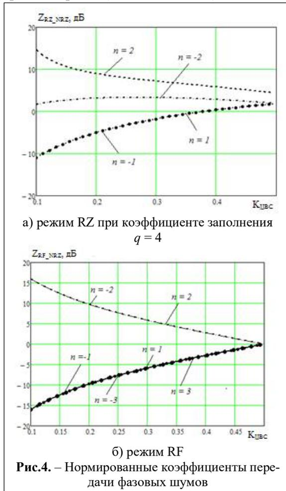
Рис.4. – Нормированные коэффициенты передачи фазовых шумов
