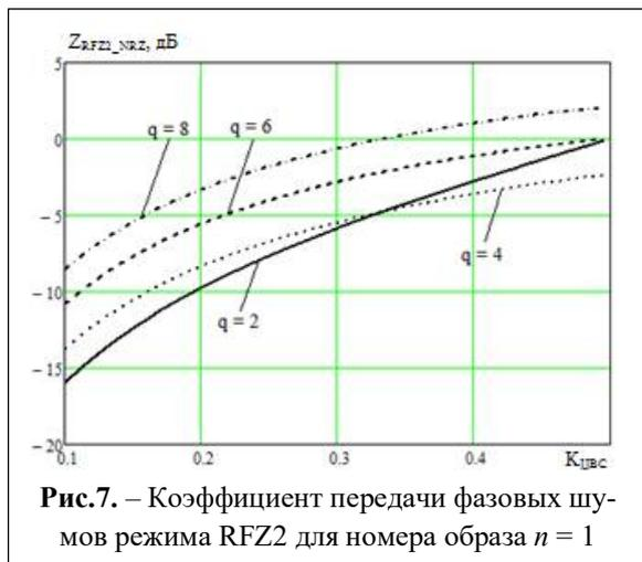
Рис. 7. – Коэффициент передачи фазовых шумов режима RFZ2 для номера образа  $n = 1$
