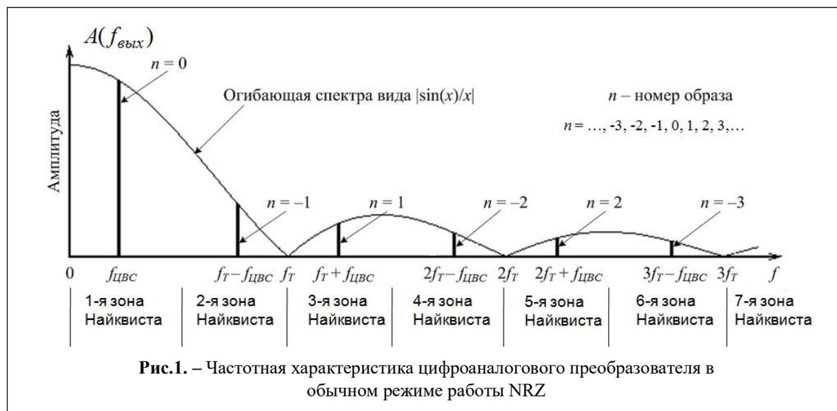
Рис.1. – Частотная характеристика цифроаналогового преобразователя в обычном режиме работы NRZ
