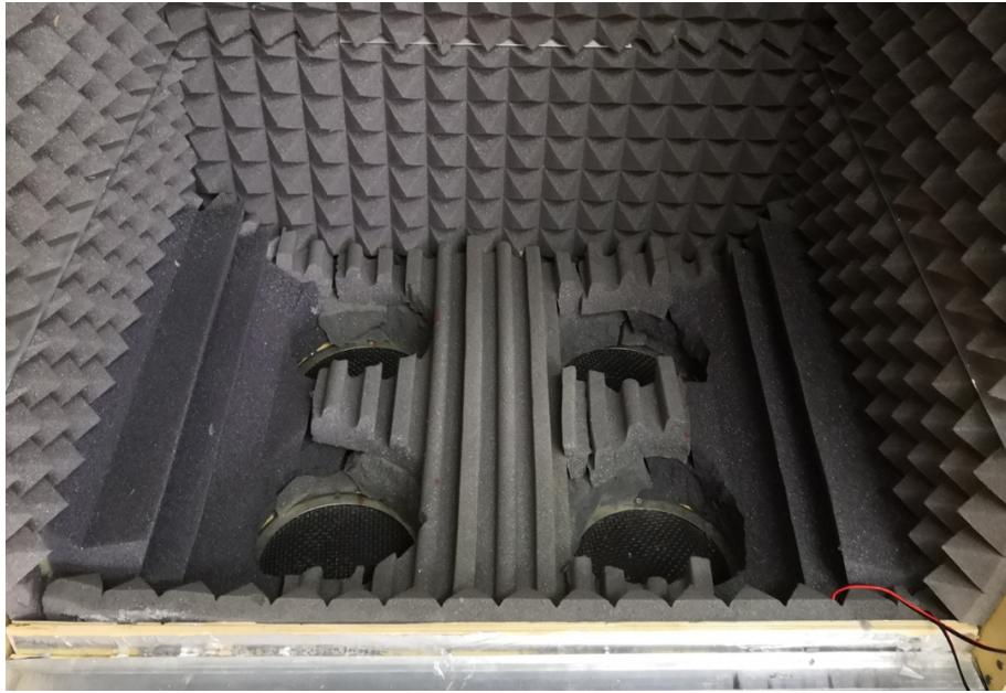
Рис. 7. Вид на установленную панель с акустическим поролоном
